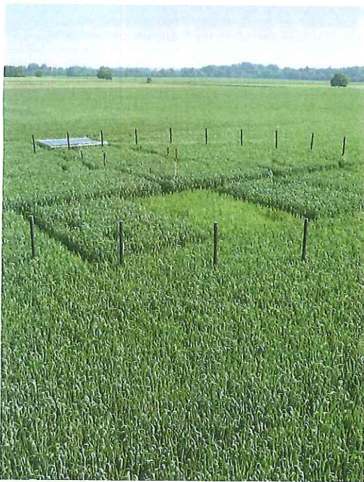
In die abgeteilte Ringfläche strömt das CO 2 -Gas, um die Konzentration dauerhaft zu erhöhen. FOTO: MANDERSCHIED
