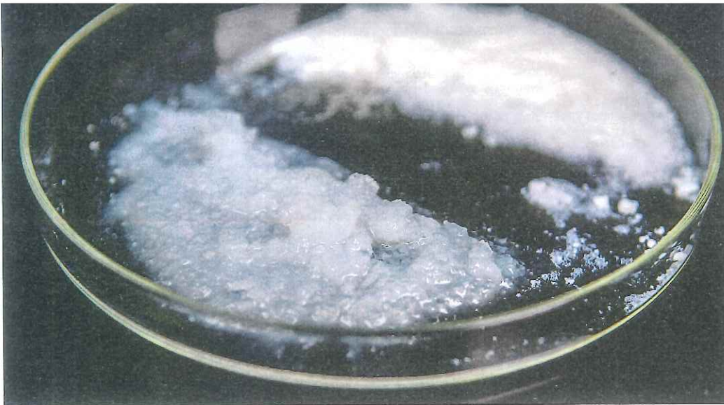
Amorphes Silikat – oben auf dem Bild getrocknet und unten gewässert – kann Wassermoleküle speichern.
